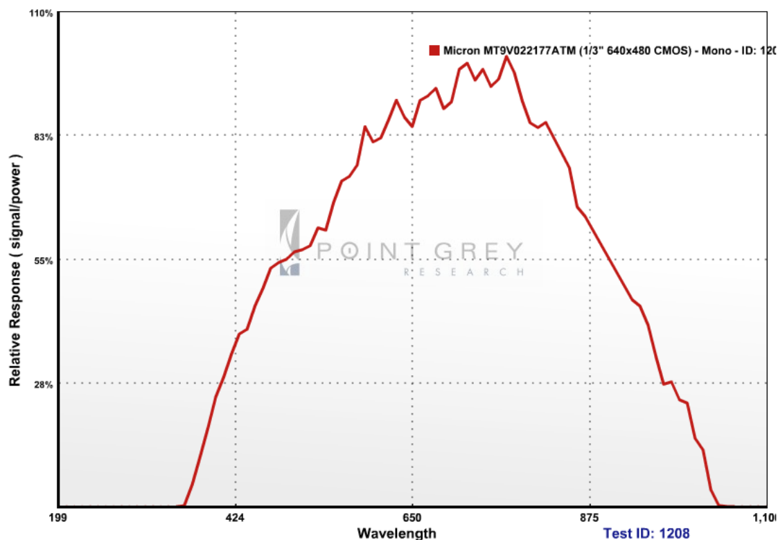
Figura 12: Gráfico da resposta relativa do sensor pelo comprimento de onda incidente neste. Fonte: (Point Grey Research, Inc, 2011)
