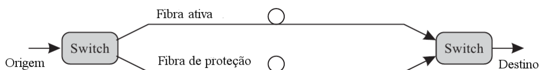
Figura 35 – Esquema de proteção 1:1. Fonte (RAMASWAMI; SIVARAJAN; SASAKI, 2010)
