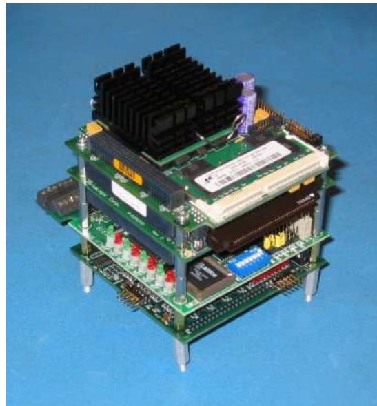
Figura 1.2: Conjunto de módulos PC/104
