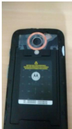
Figura 3.8: Celular com Etiqueta RFID posicionada em volta da câmera.
