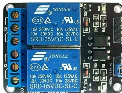
Figura 32: Módulo de 2 relés Songle SRD-5VDC-SL-C (Fonte: [14])
