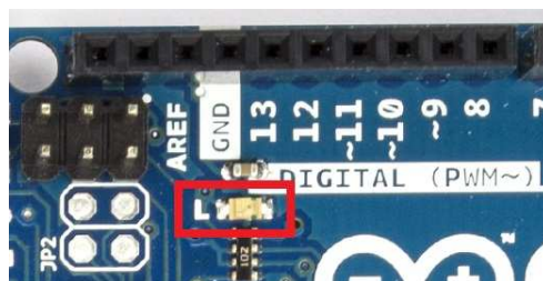
Figura 18: LED conectado ao pino digital 13 da placa, em destaque
