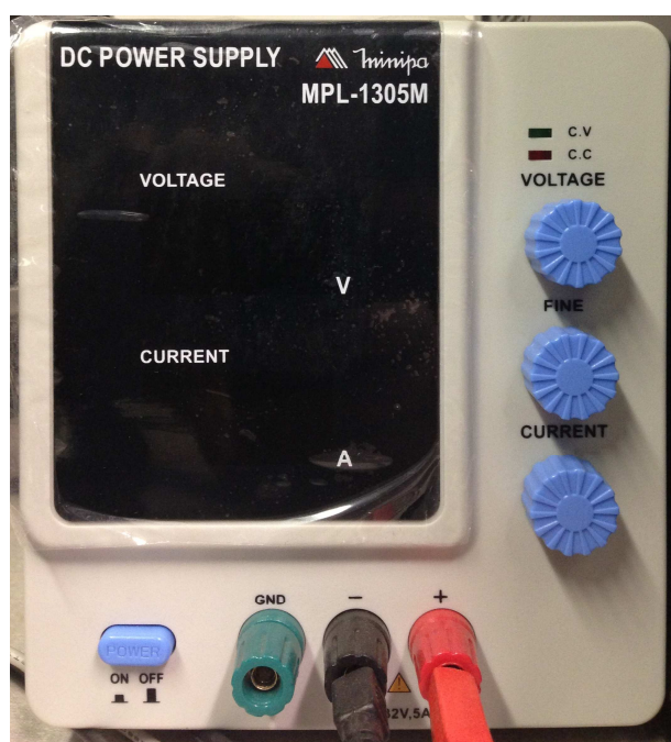
Figura 33: Fonte de tensão DC para alimentação do pressostato.
