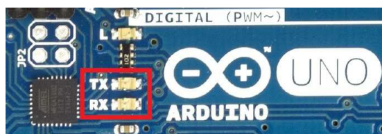
Figura 21: LEDs sinalizadores RX/TX serial, em destaque
