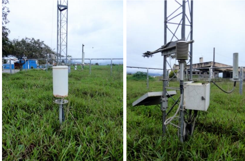
Figura 7: PCD 32521 - Caraguatatuba, localizada no bairro do Porto Novo: pluviômetro utilizado para coleta da precipitação acumulada e demais equipamentos da EMA. Azimutes 340° (Noroeste), 350° (Noroeste), respectivamente. Fotos: Denise Dias dos Santos, junho de 2013.
