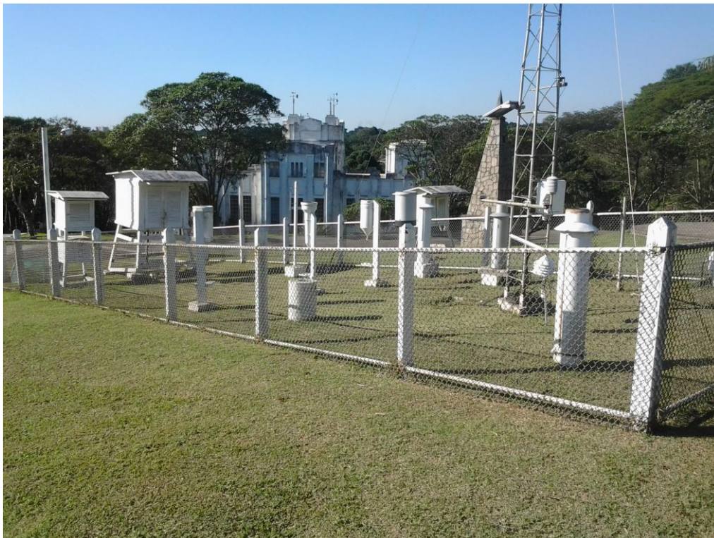
Fig.3 – Vista, para o Nordeste, do cercado meteorológico, com abrigo e estação automática. E ao fundo prédio com os demais equipamentos (anemômetro, heliógrafo, actinógrafo...).
