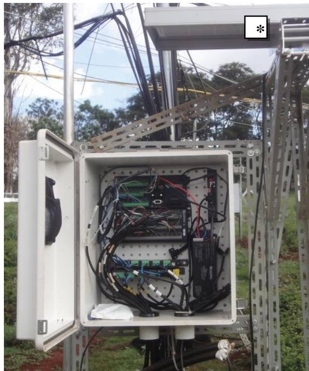
Figura 6. Unidade de controle central do sistema T-FACE. * Painel solar.
