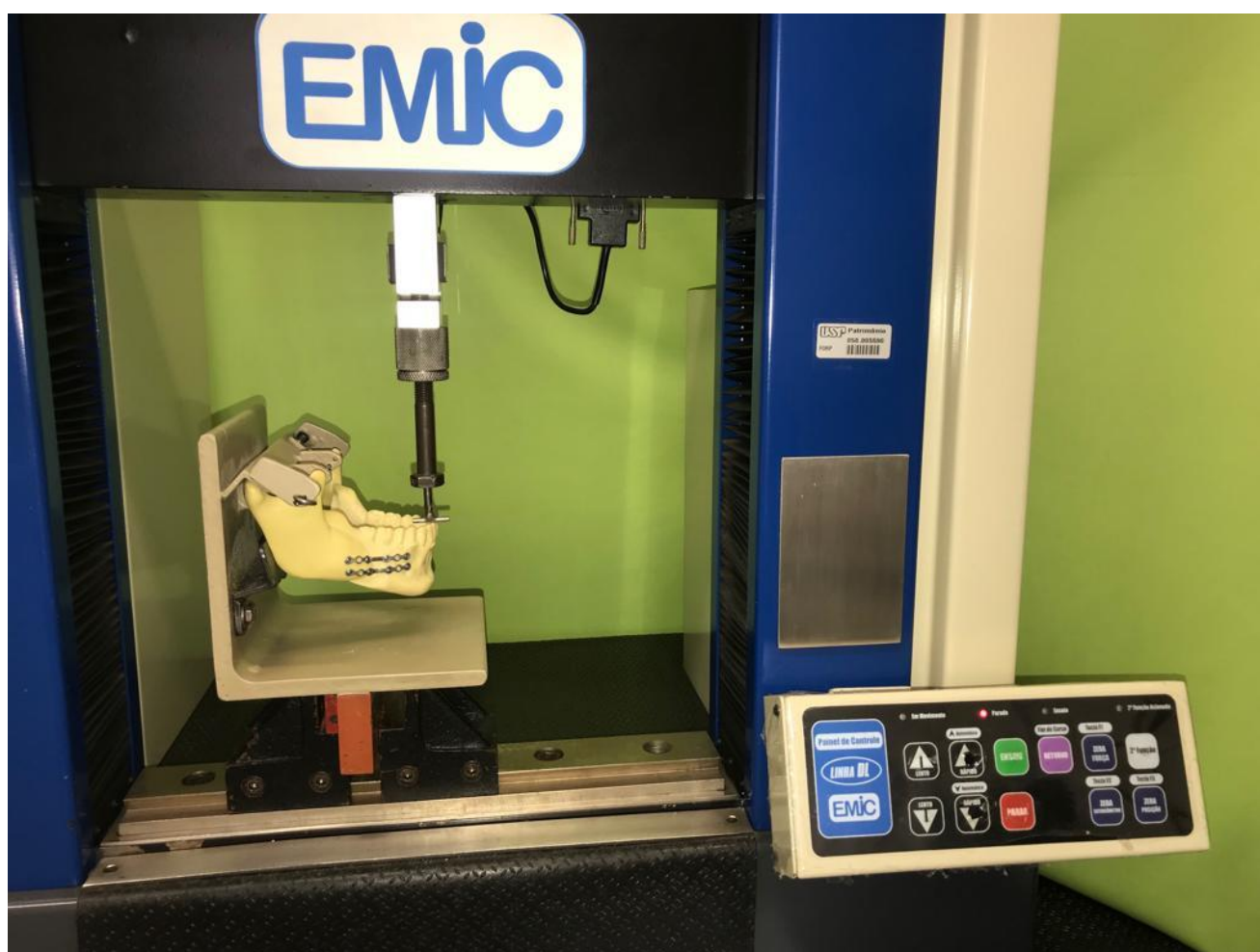
Figura 6 - Máquina universal de ensaios, da marca comercial EMIC, modelo DL200, dispositivo de aço de suporte da mandíbula confeccionado e de aplicação de força.
