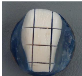
Figura 6: Cortes longitudinais e transversais
