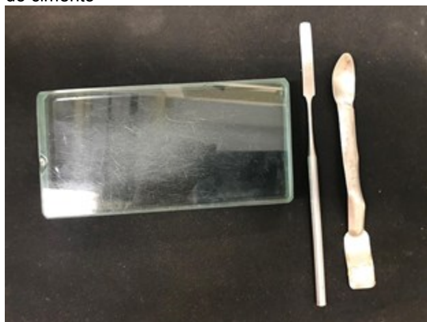
Figura 9 - Materiais utilizados para a manipulação do cimento
