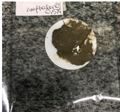
Figura 17 - Massa de cimento colocada dentro do molde de teflon junto ao fio de nylon
