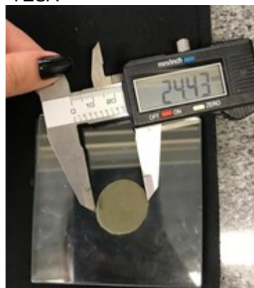
Figura 15 - Medidas do diâmetro maior e menor feitas pelo paquímetro digital marca TESA
