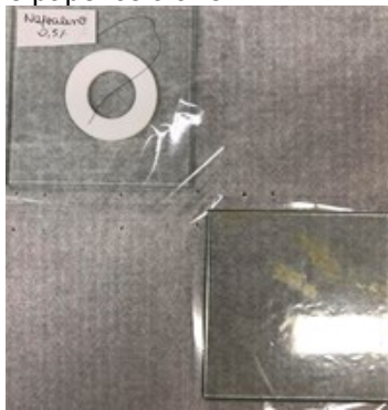
Figura 16 - Confeção dos corpos de prova utilizando moldes de teflon, fio de nylon e papel celofane
