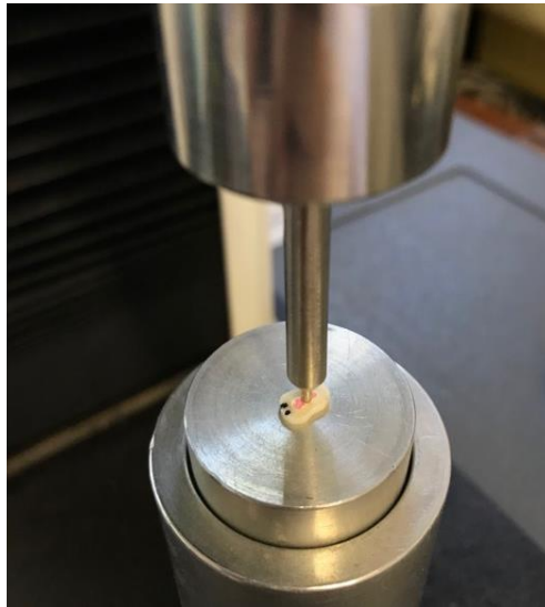
Figura 24 – 2 cortes por terço foram submetidos ao teste do Push Out
