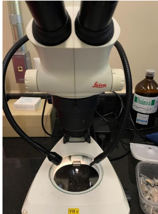
Figura 25 – Análise do padrão de falha em lupa estereoscópica
