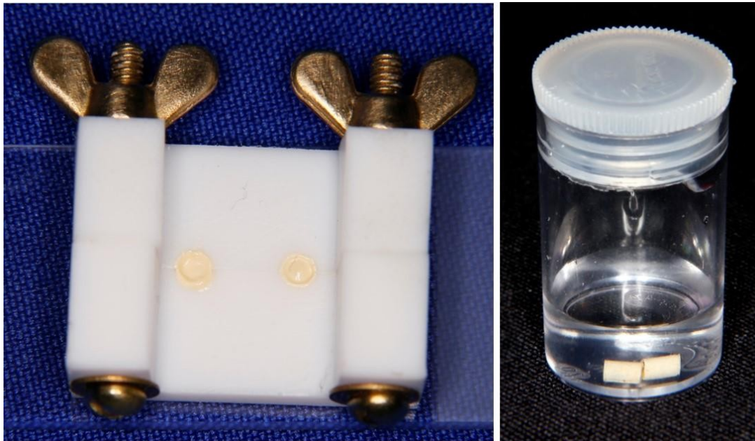
Figura 3. A) Molde de teflon preenchido com cimento para a obtenção de corpos de prova cilíndricos de 3,59 mm de altura por 3 mm de diâmetro para o teste de alteração dimensional; B) Corpo de prova imerso em 2,24 mL de água destilada, que será mantido por 30 dias para avaliação da alteração dimensional.
