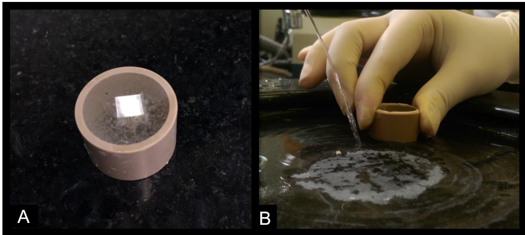
Figura 1. Preparo dos corpos de prova manualmente. (A) Espécime embutido; (B) Polimento manual do espécime.
