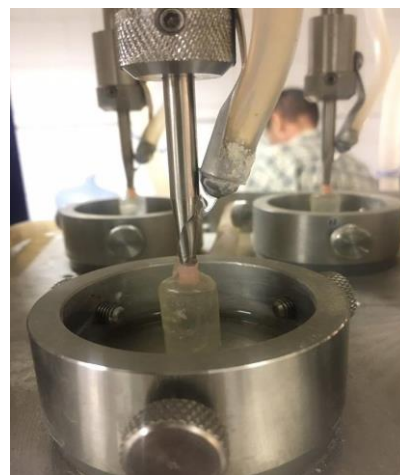
Figura 9. Equipamento de desgaste termomecânico. Figura 10. Espécimes sofrendo ciclagem termomecânica.
