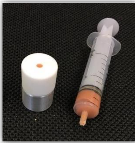
Figura 7. Inserção da resina no orifício central da matriz.
