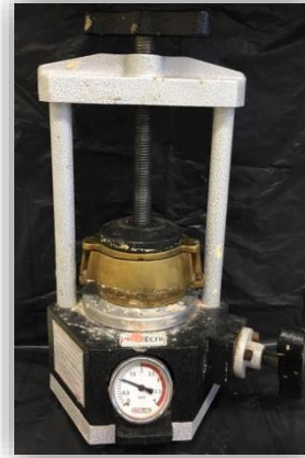
Figura 3. Prensagem da resina acrílica.
