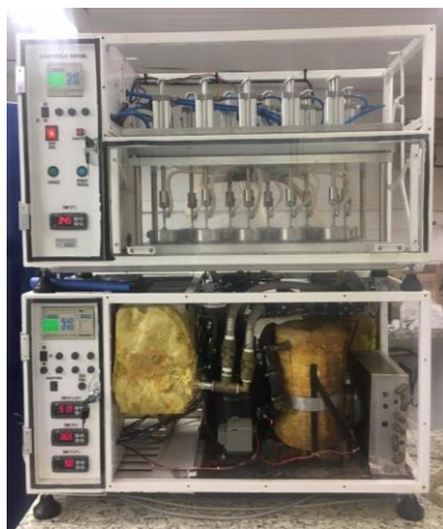
Figura 9. Equipamento de desgaste termomecânico. Figura 10. Espécimes sofrendo ciclagem termomecânica.
