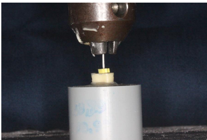
Figura 1: Momento de inclusão da raiz sem o pino cimentado.
