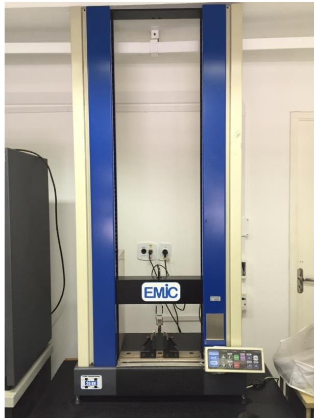
Figura 3: Máquina de Ensaio Universal EMIC DL 2000
