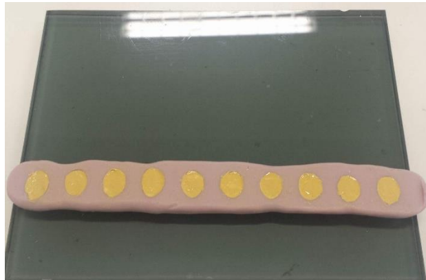
Figura 2. Molde em silicona de condensação com o cimento endodôntico.
