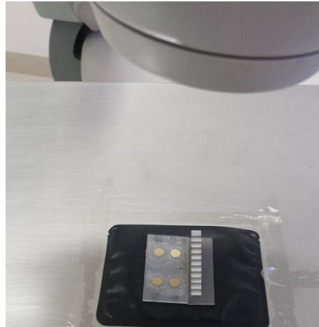
Figura 8. Placa de acrílico com os corpos de prova e escala de alumínio posicionados sobre a placa de fósforo.
