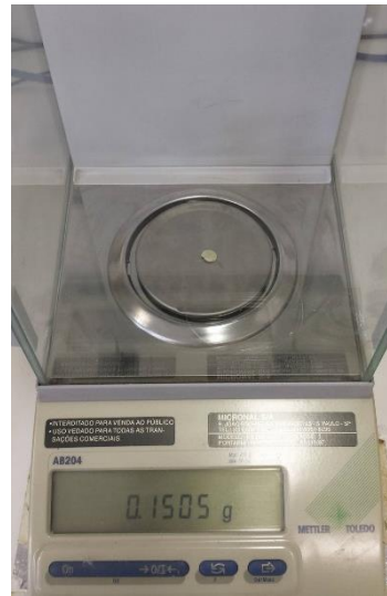
Figura 3. Aferição da massa inicial do corpo de prova em balança de precisão.
