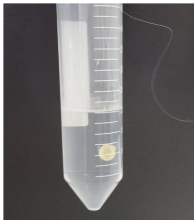
Figura 4. Corpo de prova suspenso pelo fio de nylon e colocados em tubos de polipropileno com 20 mL de água destilada e deionizada.
