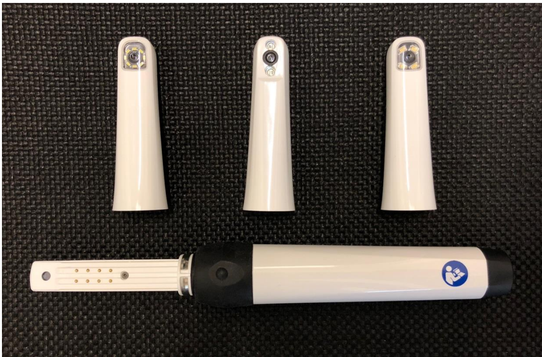
Imagem 1 – Aparelho VistaCam iX (Dürr Dental, Bietigheim-Bissingen, Alemanha) e os três cabeçotes na sequência: câmera intraoral, transiluminação e fluorescência.
