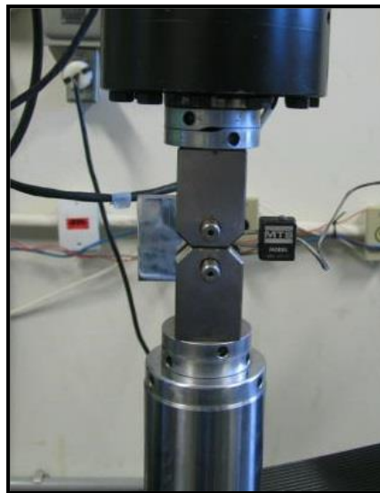
Figura 16: Corpo de prova instrumentado com extensometria do tipo clip on Gauge
