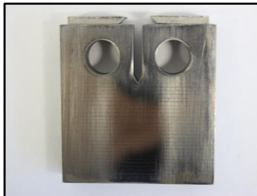
Figura 15: Corpo de prova C(T) polido e com riscos perpendiculares.
