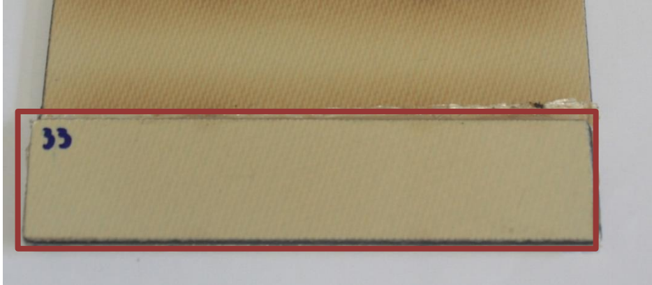
Figura 13 - Região da solda a ser cortada (região demarcada em vermelho)
