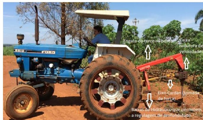
*Figura 6 - Trator com o perfurador de solo acoplado*
