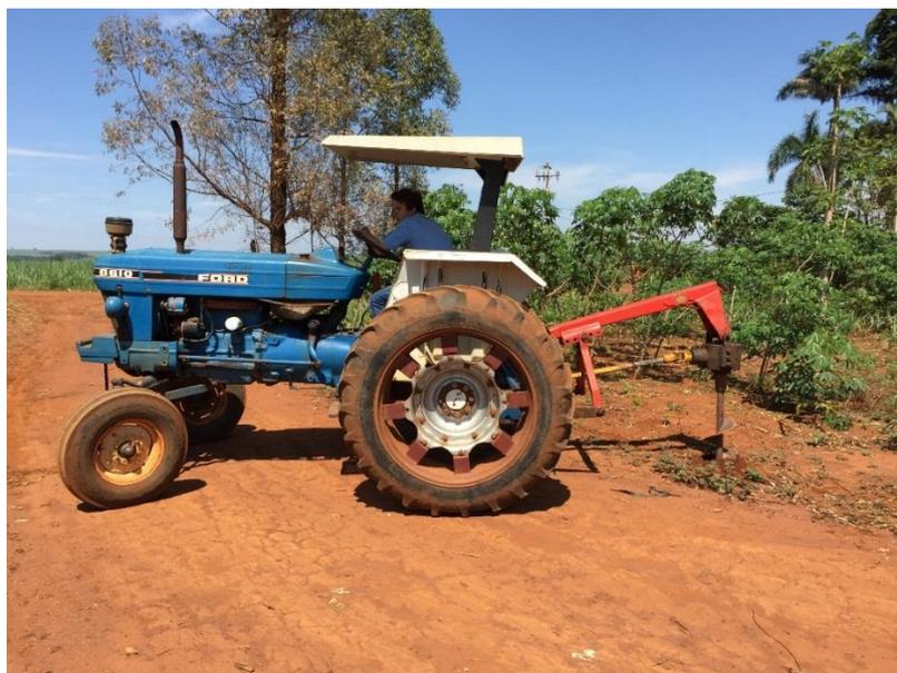
*Figura 13 - Buraco sendo executado pelo perfurador*
