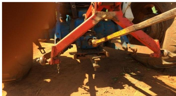
*Figura 8 - Detalhe do eixo cardan e das barras de hidráulico*
