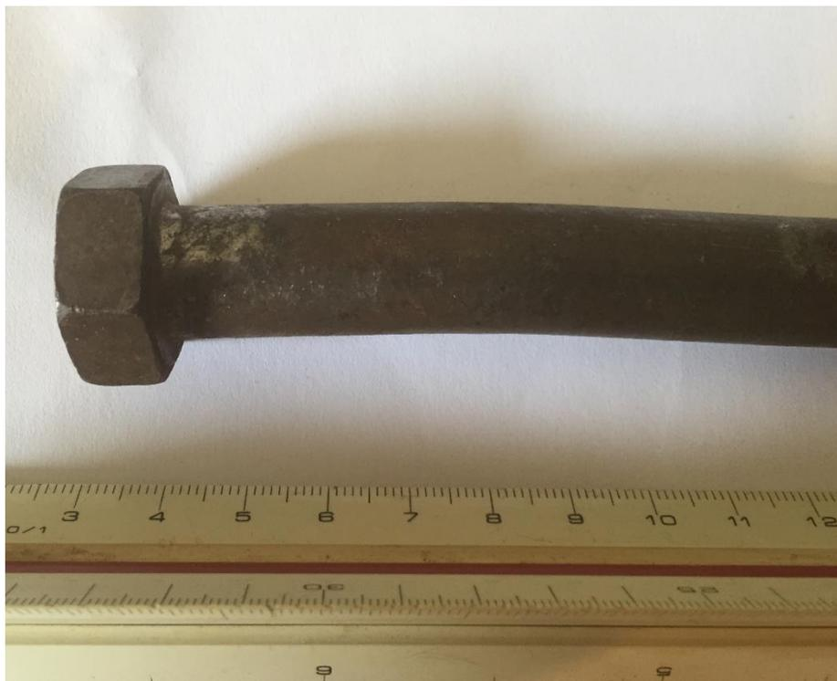
*Figura 20 - Detalhe de parafuso do grupo 3 após 8 horas de teste*
