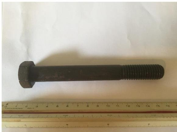
Figura 10 - Parafuso de aço classe 8.8
