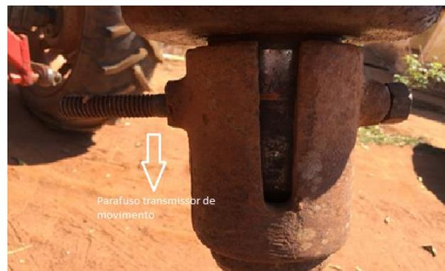
*Figura 7 - Detalhe do parafuso transmissor de movimento (componente sob análise)*
