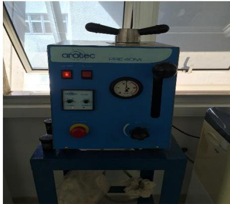
*Figura 12 - Equipamento para embutimento à quente*
