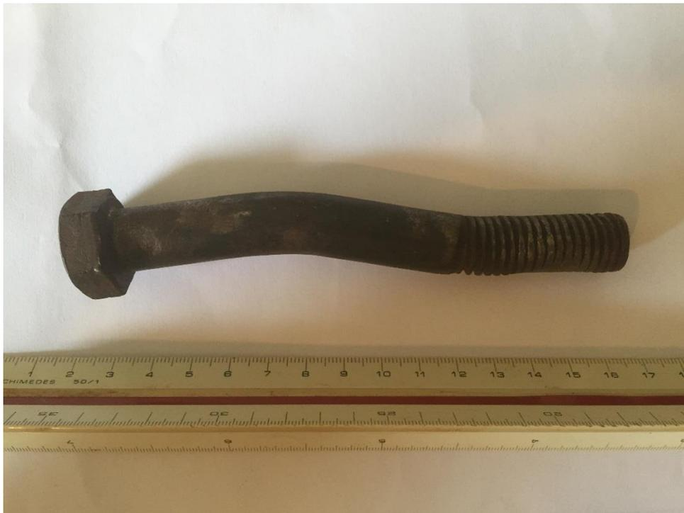
*Figura 17 - Parafuso do grupo 2 deformado após teste*
