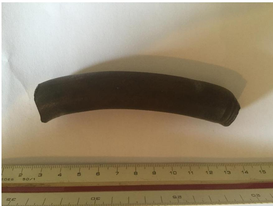
*Figura 16 – Parafuso deformado e fraturado após teste*
