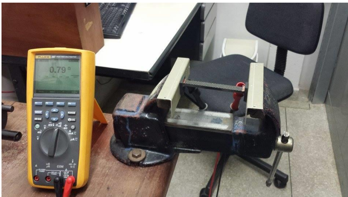
Figura 24. Aparato para medição da condutividade da amostra constituído de uma morsa, apoios de material isolante, folhas de papel alumínio e multímetro. As folhas de alumínio foram utilizadas para passagem uniforme de corrente elétrica no corpo de prova
