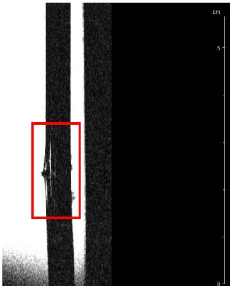
Figura 12. Imagem obtida em corte Sagital de espécime EPX-FC fraturado intralaminarmente e subsequente imerso em SSFCH a 25°C, segundo protocolo FLASH. Em vermelho é destacada a fratura classe interlaminar ocorrendo em planos paralelos ao de deposição das camadas individuais do laminado compósito durante sua manufatura.
