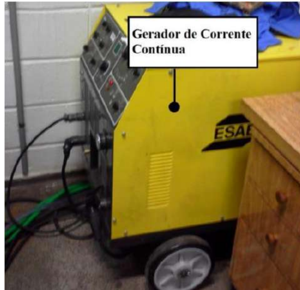
Figura 3 - Gerador de corrente contínua utilizado na fusão e das amostras.
