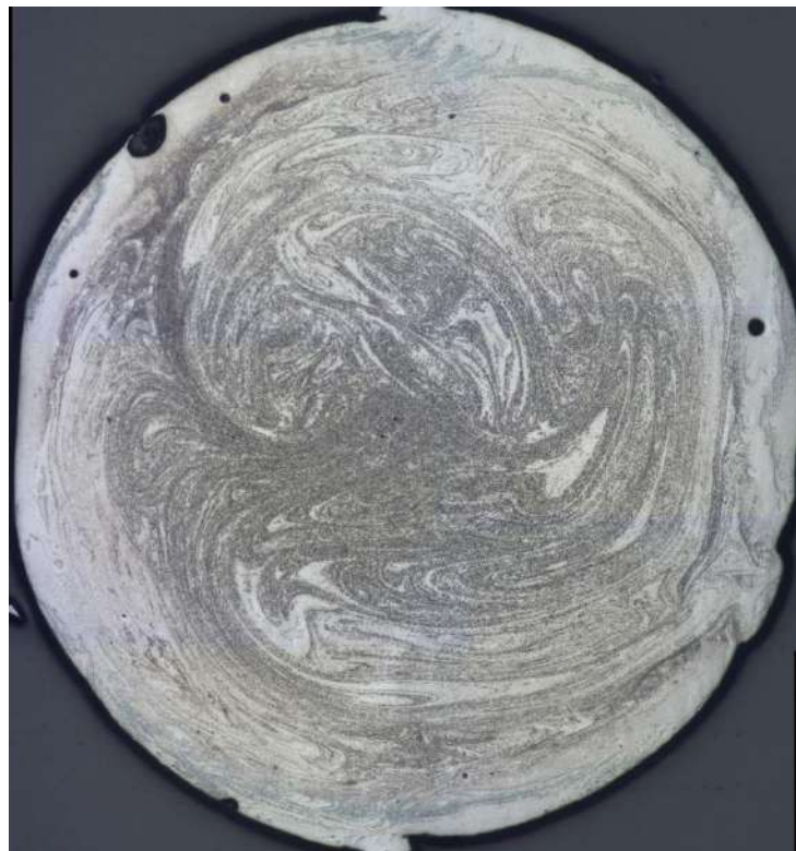
Figura 7 - Exemplo de imagem obtida com o uso de microscópio óptico. Neste caso está ilustrada a amostra de 4 mm de composição Zr_{62}Cu_{15.5}Al_{10}Ni_{12}Nb_{0.5} .
