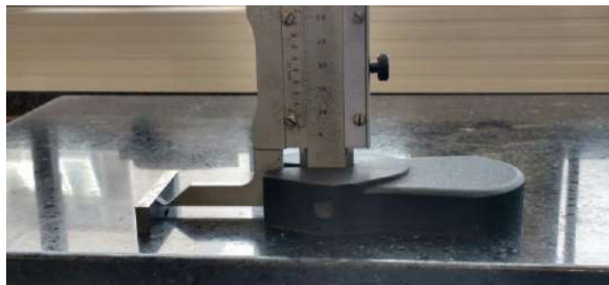
Figura 33- Definição do tamanho da trinca inicial do ensaio por meio do traçador de altura
