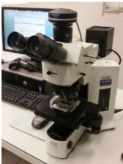
Figura 29- Microscópio Óptico modelo BX51M, marca Olympus utilizado na análise microestrutural
