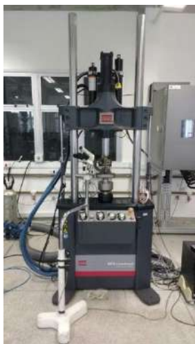
Figura 34- Nucleação da pré-trinca por fadiga: disposição dos equipamentos durante o ensaio (à esquerda); b) posicionamento do corpo de prova (à direita)
