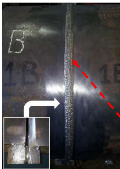
Figura 25 - Calotas soldadas por arco submerso com a seta pontilhada indicando o sentido de laminação
