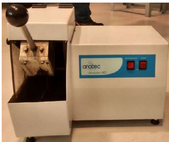
Figura 28 - Máquina de corte de precisão Arotec modelo acrorcor 40
