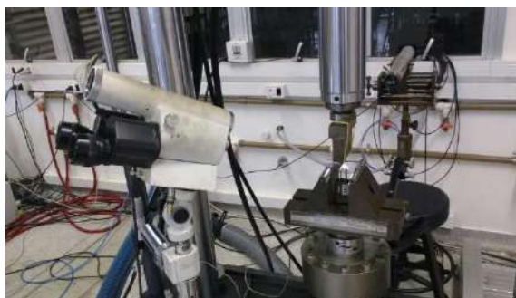
Figura 35- Observação do crescimento da pré-trinca na parte frontal e posterior do corpo de prova por meio de lunetas
