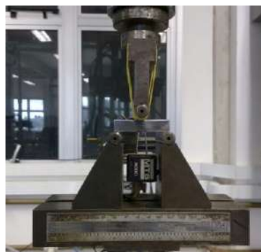
Figura 34- Nucleação da pré-trinca por fadiga: disposição dos equipamentos durante o ensaio (à esquerda); b) posicionamento do corpo de prova (à direita)
