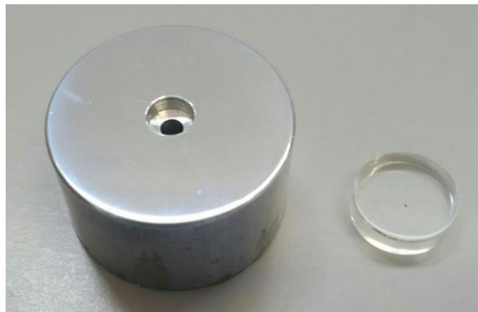
Figura 22 - Amostras a serem microfresadas, de RSA e PMMA, respectivamente.
