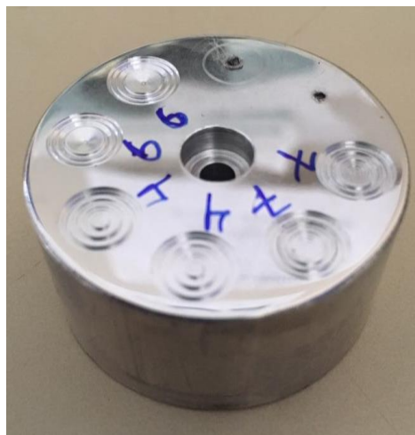
Figura 34 - Amostra de RSA 6061 com moldes 4, 6, e 7 microusinados.
