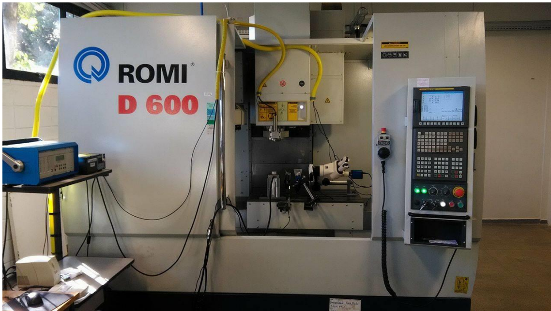
Figura 20 - ROMI D 600 acoplado com spindle de 50000 rpm.
