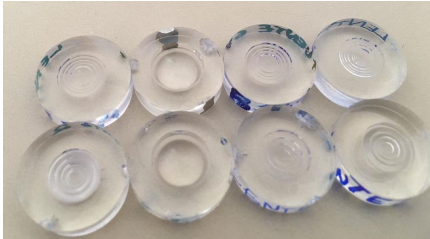
Figura 35 - Amostras de PMMA com as lentes microusinadas.
