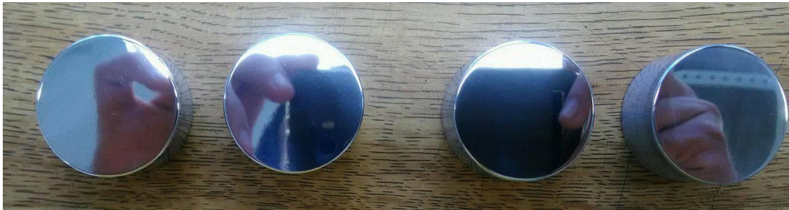
Figura 24 - Amostras de RSA 6061 após polimento com pasta de diamante.
