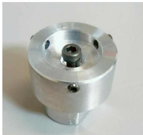
Figura 23 - Suporte de fixação para microfresagem de amostras de RSA 6061.
