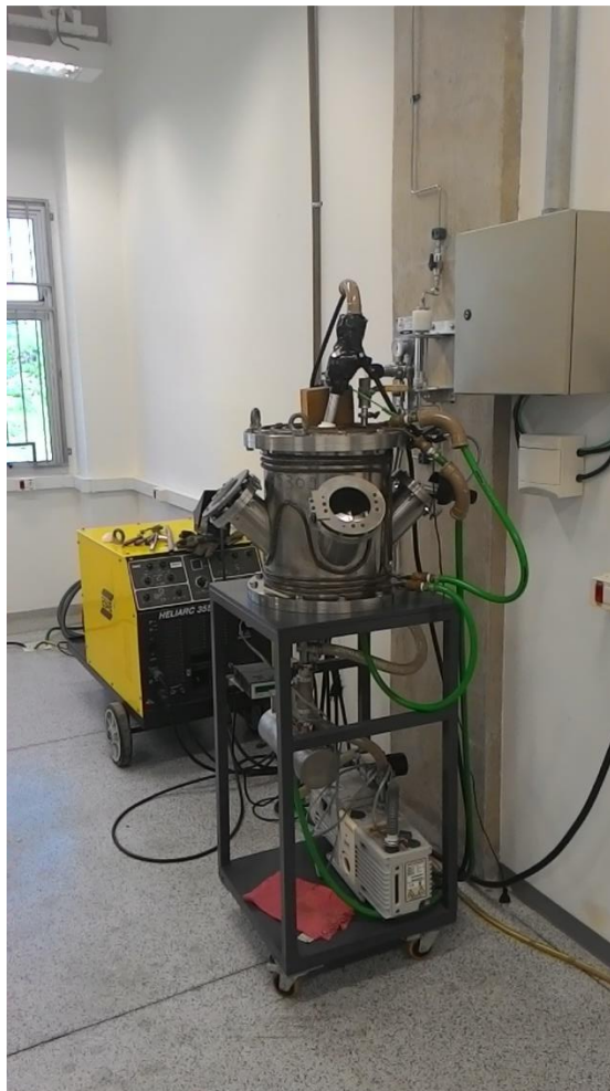
Figura 3 - Forno a arco utilizado no preparo das amostras
