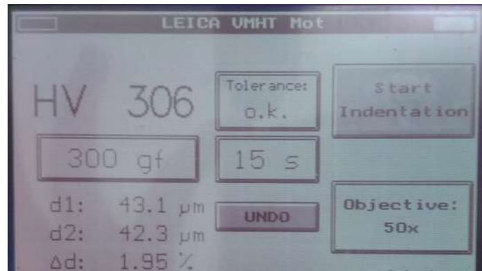
Figura 24 - Tela do microdurômetro, mostrando os valores relevantes para a análise.
