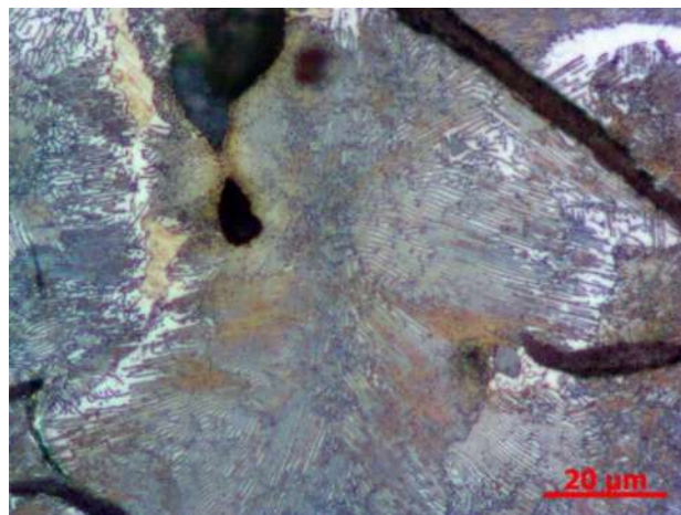
Figura 33 - CP1, aumento de 1000x, ataque com nital 2%, estrutura perlítica com veios de grafita.
