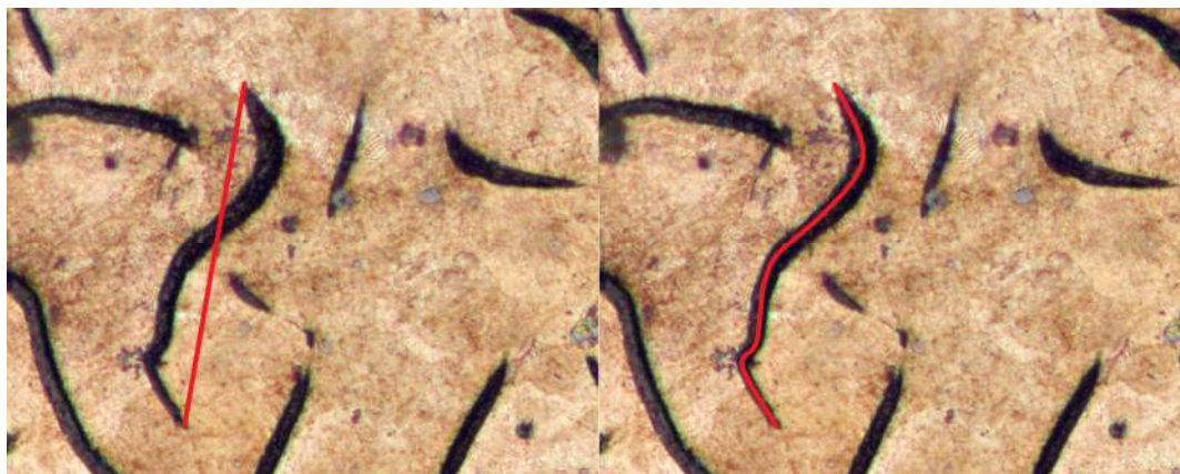
Figura 36 - Medição pelo software (esq.) 120 \mu\text{m} e medição manual (dir.) aproximadamente 158 \mu\text{m} .
