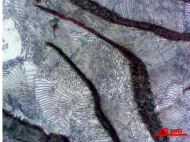
Figura 34 - CP5, aumento de 1000x, ataque com nital 2%, estrutura perlítica com veios de grafita.
