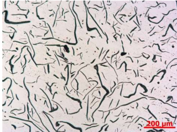
Figura 32 – Classe 25 100x de aumento, sem ataque, apresentando grafita tipo VII-A-C 3-4-5.
