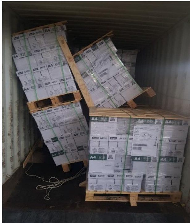
Figura 7 - Pallets dentro do contêiner tombados e avariados.
