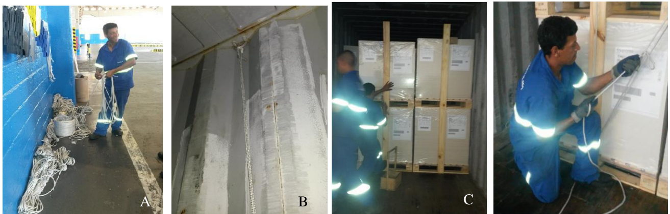
Figura 10 - A: Preparação das cordas; B: Posicionamento das amarras no contêiner; C: Posicionamento dos sarrafos e calços de madeira; D: Nó final dado pelo operador.
