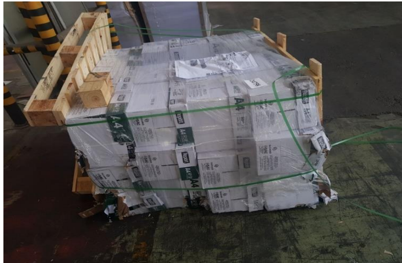
Figura 8 - Pallet e embalagem de papel tipo cut-size avariados após retirada do contêiner.
