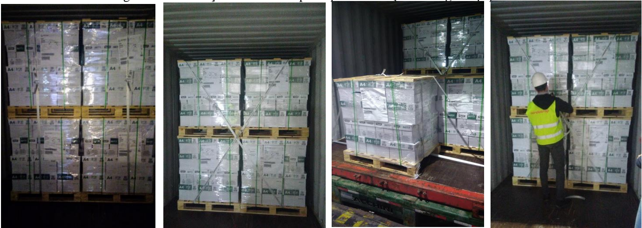
Figura 13 - Utilização da cinta composta para contenção de carga de papel em contêiner.
