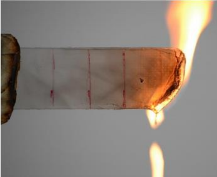
Figura 13. Ensaio de inflamabilidade do polipropileno puro (PP)
