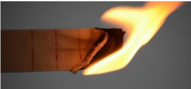
Figura 14. Ensaio de inflamabilidade do compósito 3C
