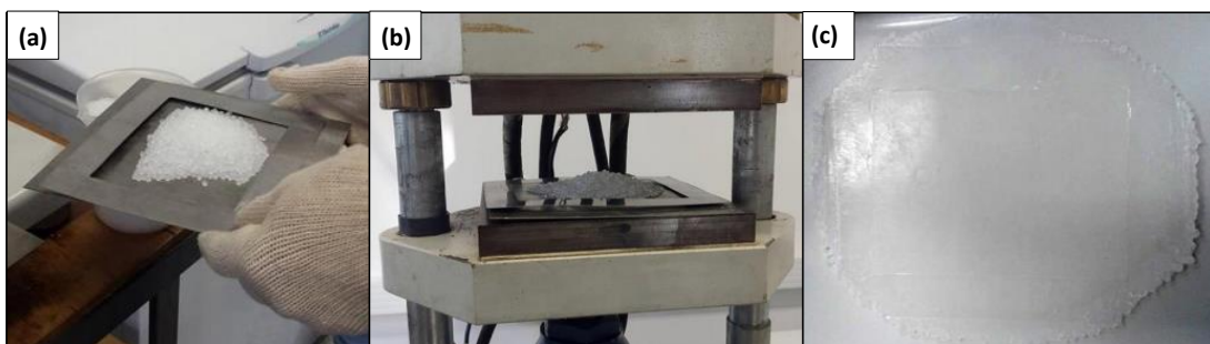
Figura 7. Etapas da prensagem do polipropileno. (a) Material na chapa de aço e molde. (b) Pellets de polipropileno na prensa durante aquecimento, aguardando estabilização. (c) Filme prensado pronto,
