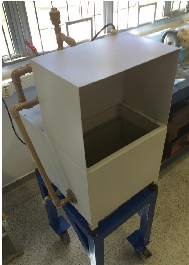
Figura 15- Tanque de resfriamento.
