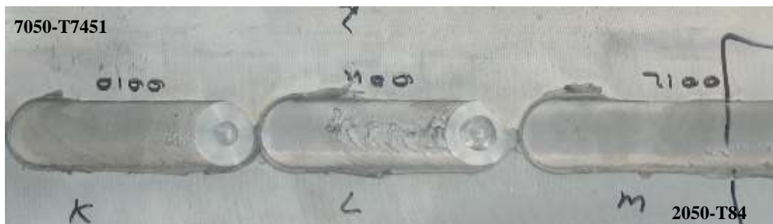
Figura 24. Testes realizados para a determinação de parâmetros das juntas de topo das ligas de alumínio-lítio 2050-T84 com 7050-T7451 por FSW.
