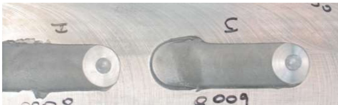
Figura 23. Testes preliminares realizados no metal base da liga 7050 para determinação dos parâmetros de soldagem.
