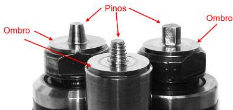
Figura 3. Ferramenta com destaque para as regiões do pino e do ombro (CAPELARI, 2006).
