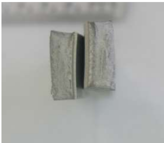
Figura 26. Ensaio de dobramento para verificação da efetividade da solda.
