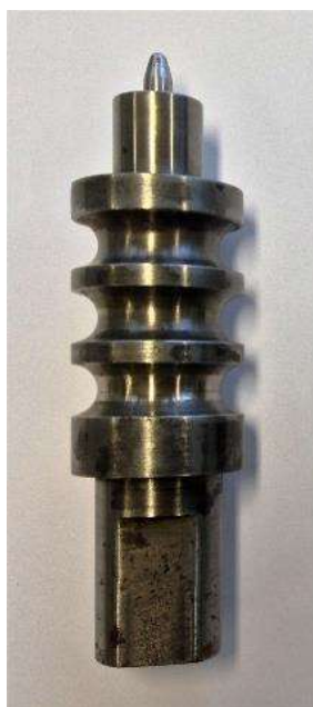
Figura 17. Ferramenta fabricada para soldagem através do processo FSW.
