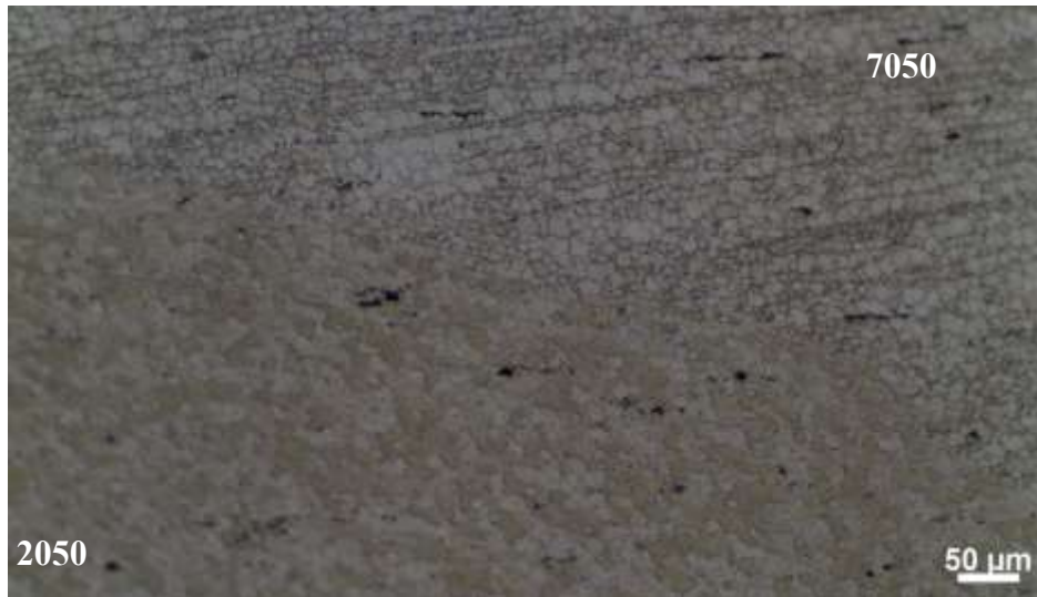
Figura 32. Microscopia ótica da interface das ligas de alumínio na região do cordão de solda.
