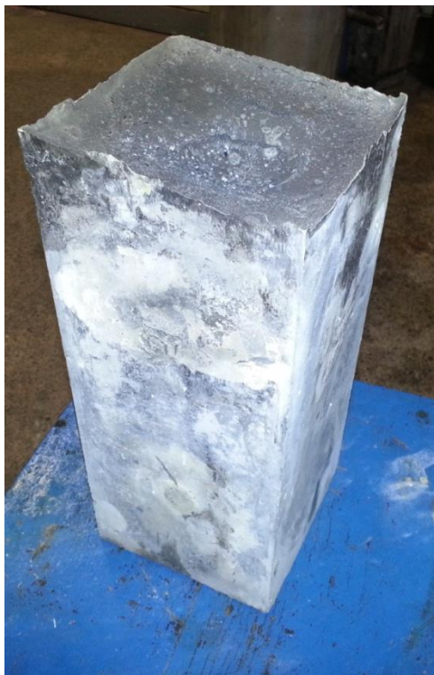
Figura 18. Tarugo obtido pelo processo de fundição em estado semi-sólido sob agitação mecânica.
