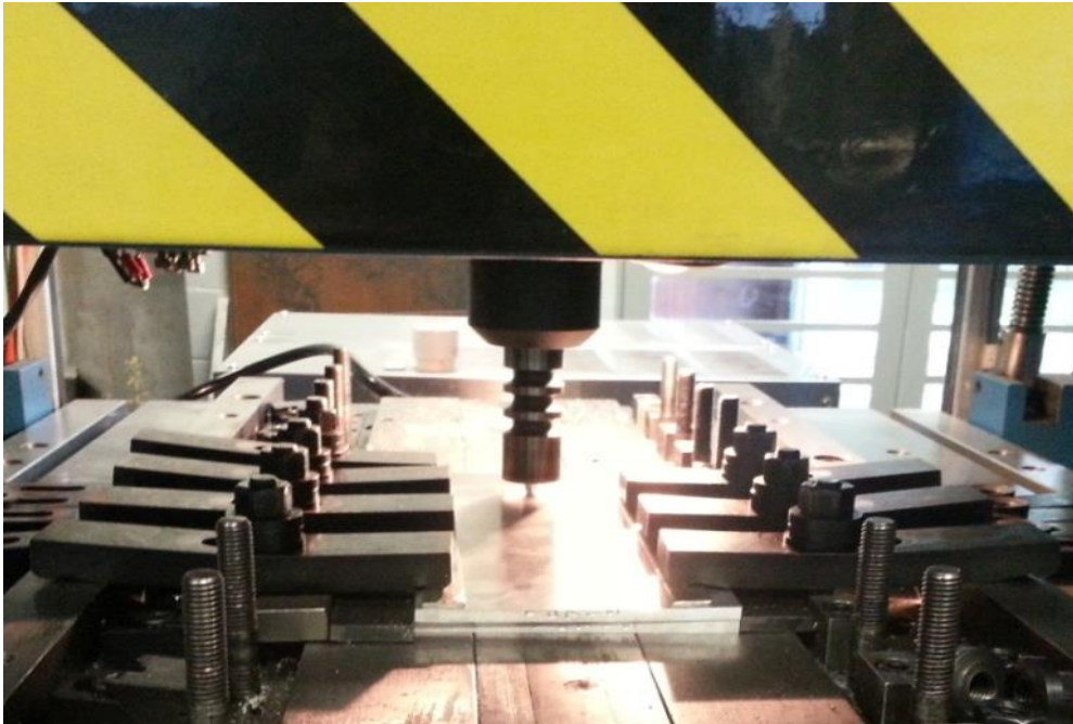
Figura 12. Montagem das chapas e equipamentos para a realização da soldagem.
