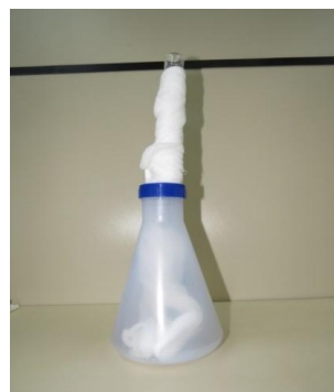
Figura 6 - Ilustração da vela úmida. Figura 7 - Fotografia da vela úmida produzida para a análise.
