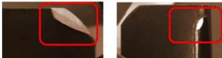
Figura 12 - Foto de delaminação ocorrida no reforço em teste de MQS
