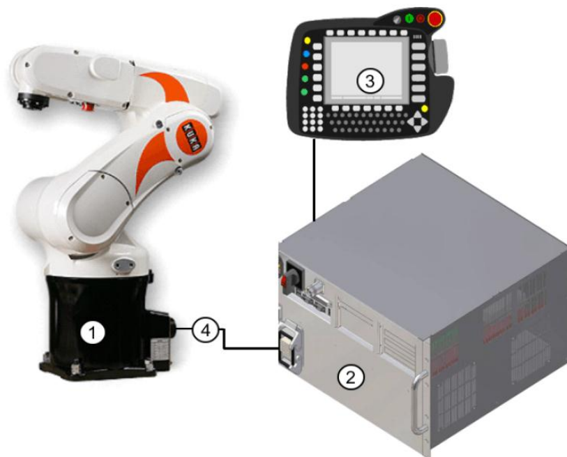
Figura 4. 1) Robô manipulador, 2) Unidade de controle do robô, 3) Unidade manual de programação: KCP, 4) Cabos de conexão (10)
