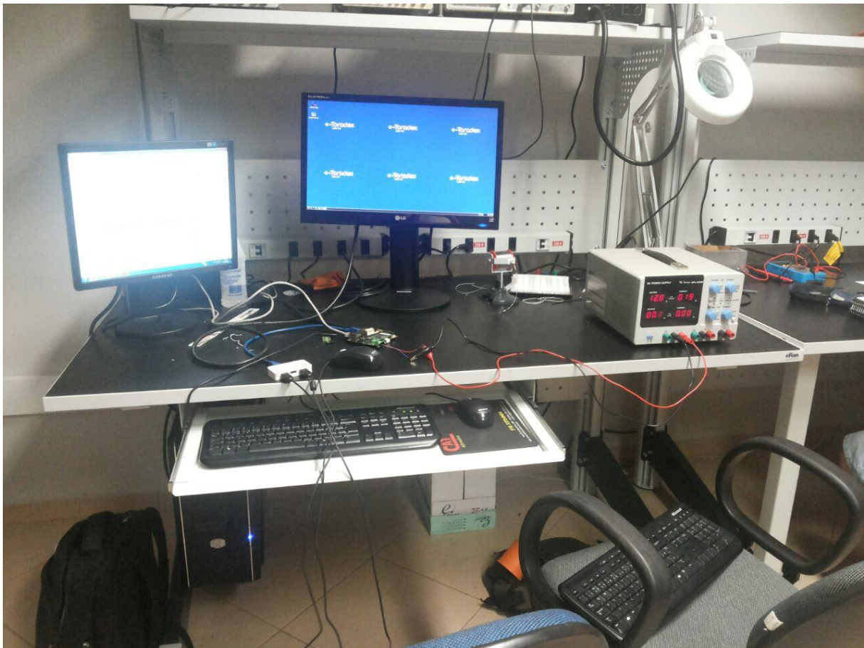
Figura 27 - Placa ligada a monitor, teclado e mouse. Corrente de 3 A é suficiente para suportar a câmera
