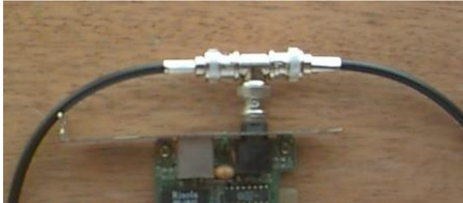
Figura 9 - Cabos coaxiais com o conector em “T”.
