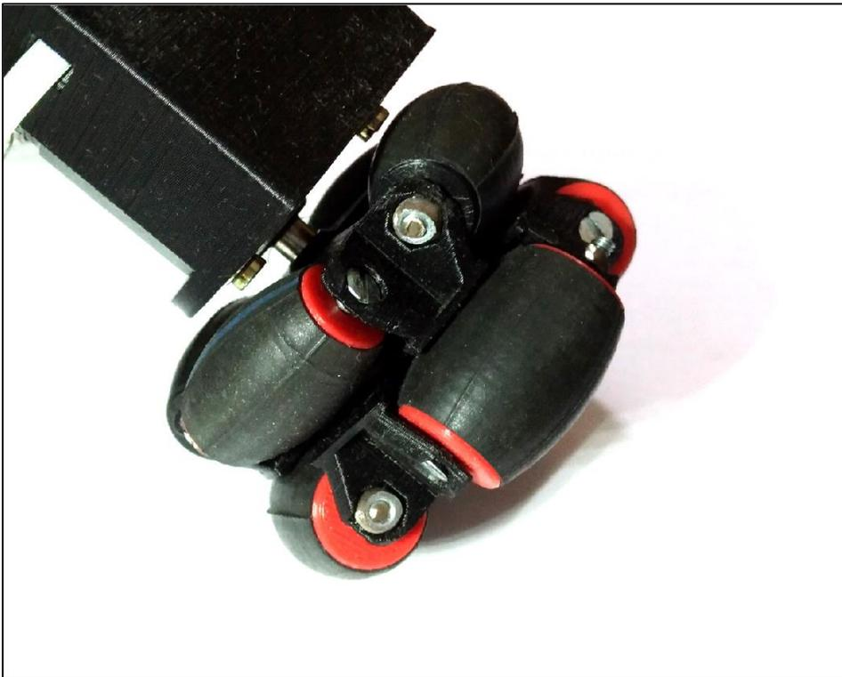
Figura 15 – Foto da roda impressa e montada
