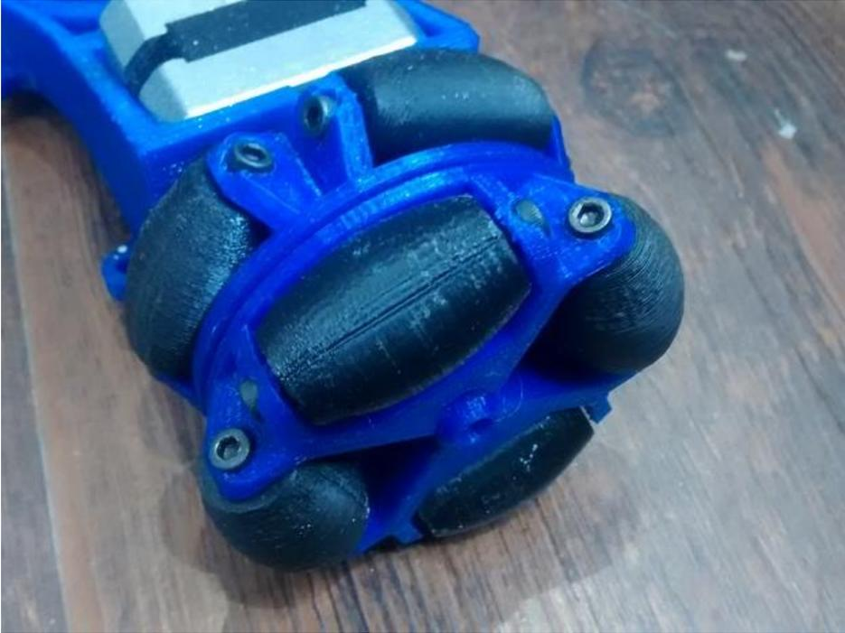
Figura 11 – roda omnidirecional utilizada como modelo
