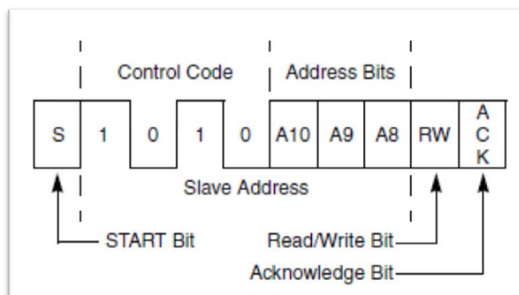
Figura 17 – Estrutura do byte de controle [7]
