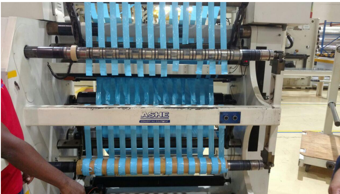
Figura 22: composição das bobinas de saída da Cortadeira 02 (fonte: empresa).
