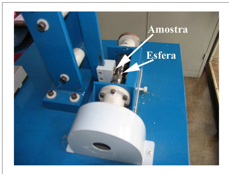
Figura 11: Equipamento de microdesgaste do LaES utilizado. Retirado de Heck (2010)
