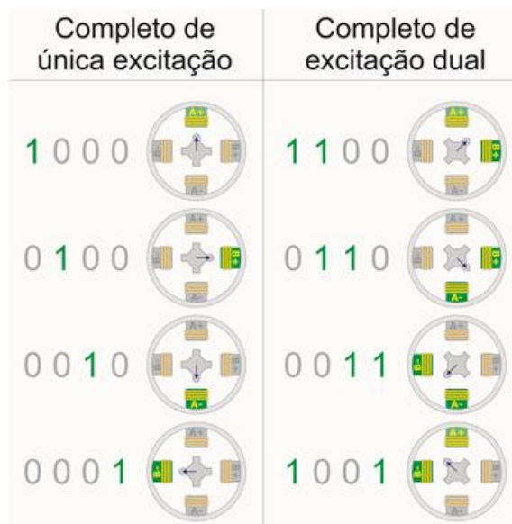
Figura 4 - Modos de operação de motores de passo: única excitação e excitação dual Fonte: Adaptado de MESSIAS (2006)
