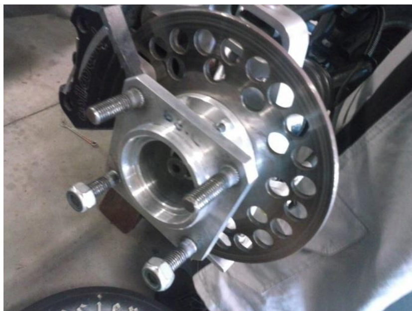
Figura 26 - Montagem de disco de freio no cubo de roda - Protótipo EX (Fonte: Acervo Equipe EESC -USP FSAE)
