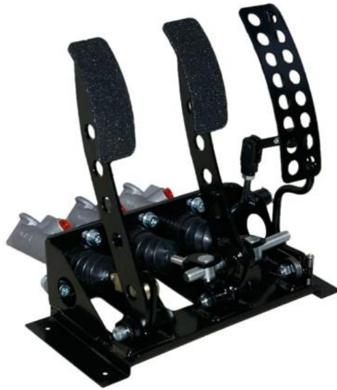
Figura 19 - Disposição convencional dos cilindros mestres nos pedais de freio (fonte: www.wilwood.com/Pedals )
