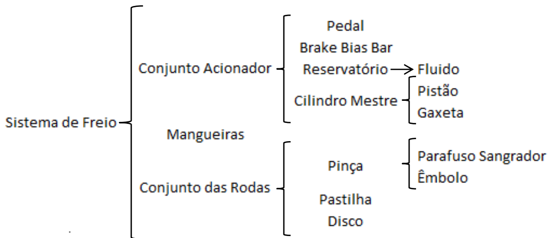
Figura 42 – Divisão dos elementos básicos do sistema de freios.
