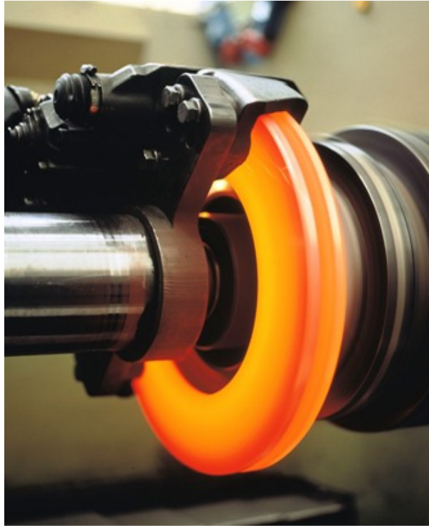
Figura 7 – Disco de freio submetido à situação extrema de frenagem. 7
