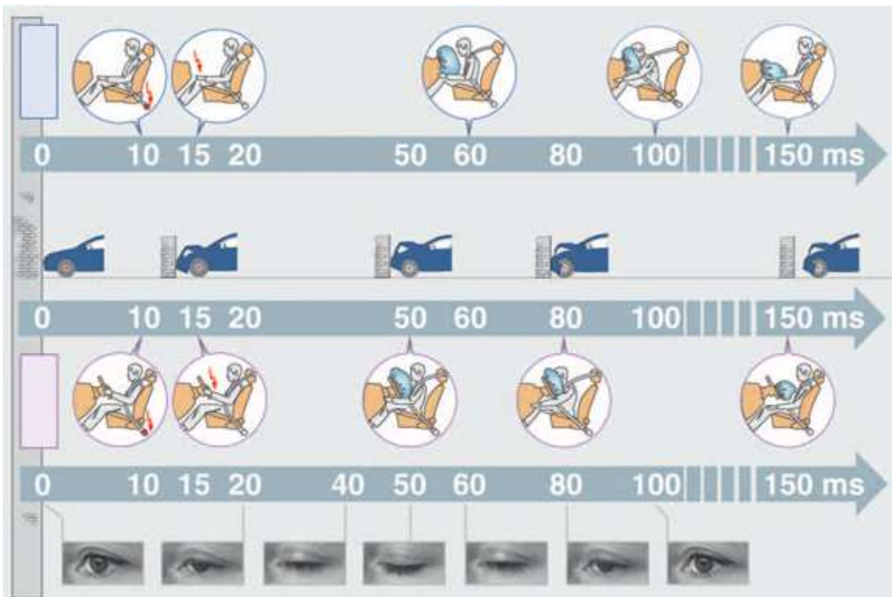
Figura 2.1 – Tempo de abertura de um airbag . (Fonte: Takata do Brasil S.A. Brasil S.A.)
