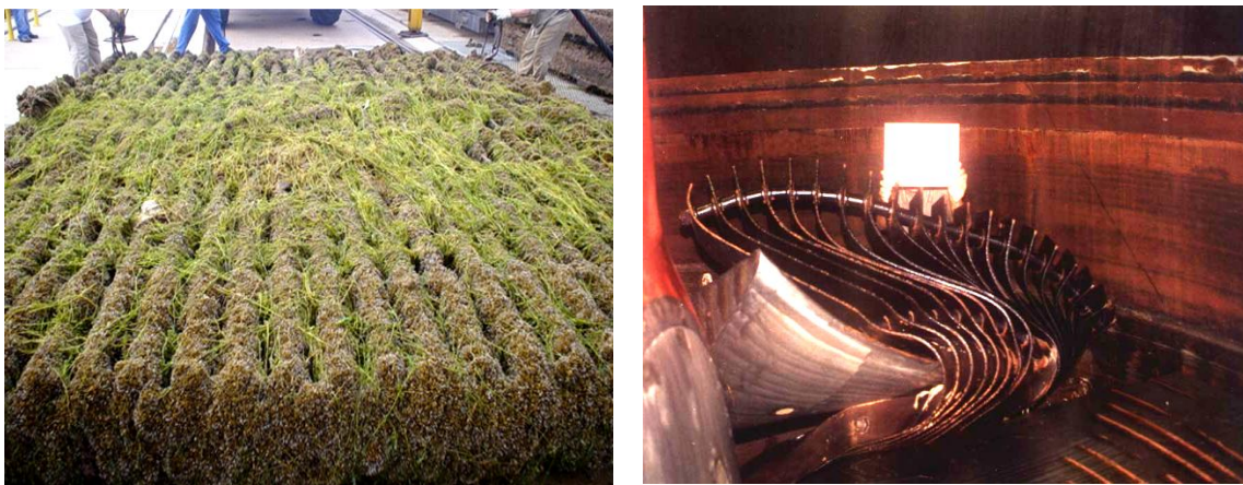
Figura 2 – À esquerda grade tomada por mexilhões, à direita rompimento de grade devido ao aumento do arraste hidrodinâmico em razão do acúmulo de plantas e mexilhões.
