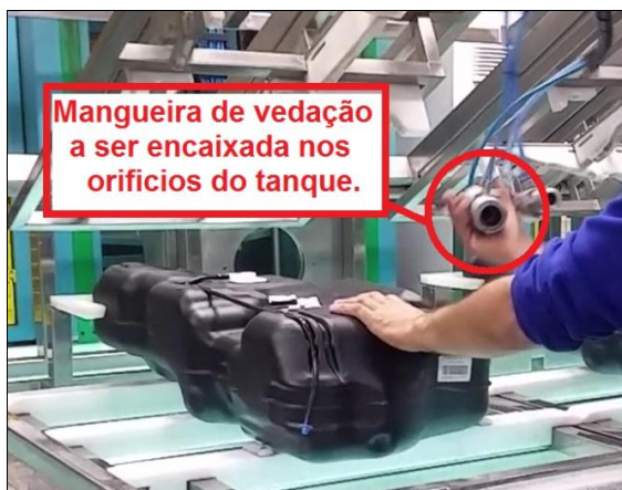
Figura 15: Vedação do tanque para teste de estanqueidade (vazamaneto)
