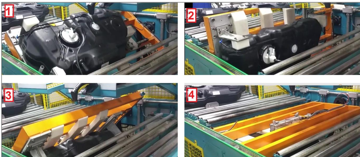
Figura 14: Rotacionamento do tanque em 180 graus para simulação de estado “cheio”.
