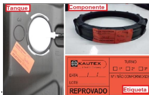
Figura 21: Identificação de tanque e componente NOK e detalhe da etiqueta utilizada.
