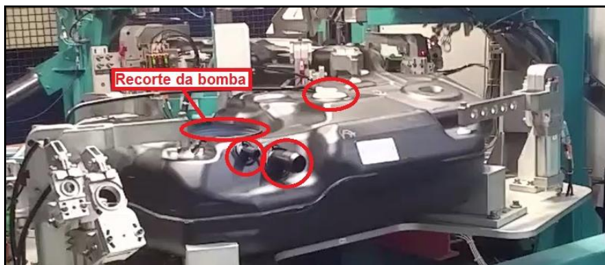
Figura 8: Tanque após operação da máquina acabadora.
