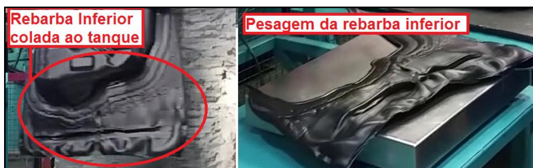
Figura 2: Rebarba inferior do tanque a ser pesada e registrada pelo CAQ.
