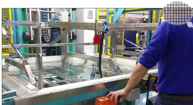
Figura 17: verificação de vazamento visual.
