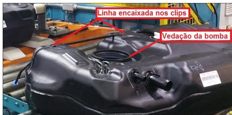
Figura 9: Tanque pronto para montagem da bomba.
