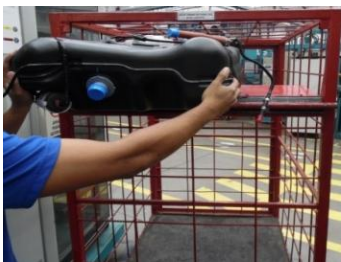
Figura 22: Segregação de tanques NOK em rack vermelho.
