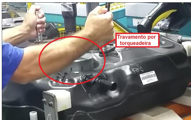
Figura 12: Travamento por torqueadeira do anel plástico de travamento
