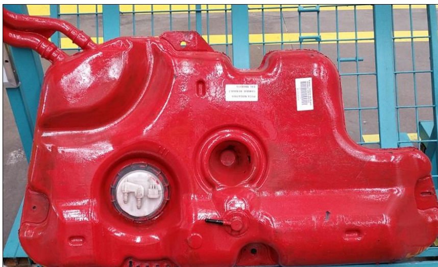
Figura 20: exemplo de peça vermelha para verificação de Poka Yoke de máquina.
