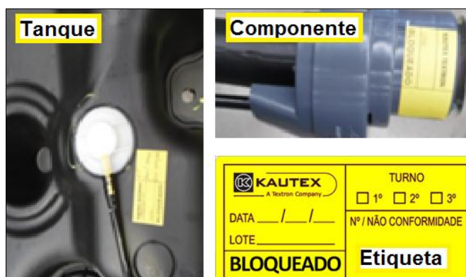
Figura 23: Identificação de tanque e componente bloqueados e detalhe da etiqueta utilizada.
