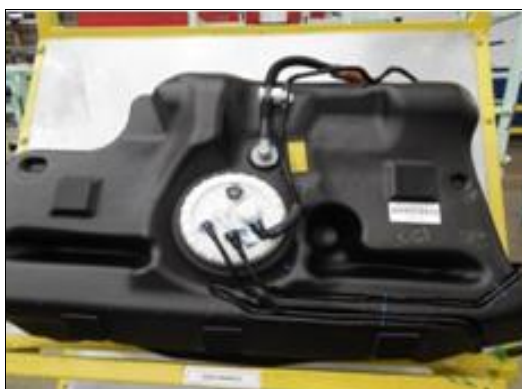
Figura 24: Bloqueio de tanques para inspeção em rack amarelo.
