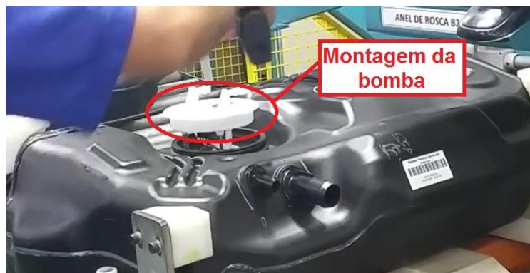
Figura 10: Posicionamento da bomba de combustível dentro do tanque e escaneamento do componente.
