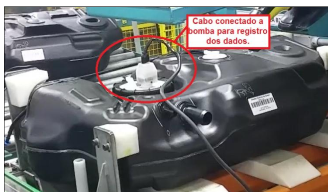
Figura 13: Conectando o cabo para teste da bomba
