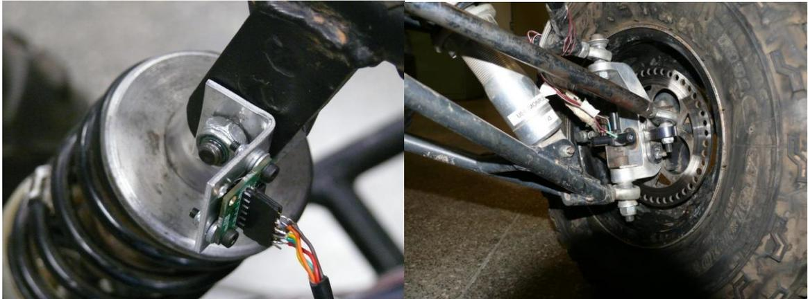
Figura 44: Montagem dos acelerômetros para teste de queda.
