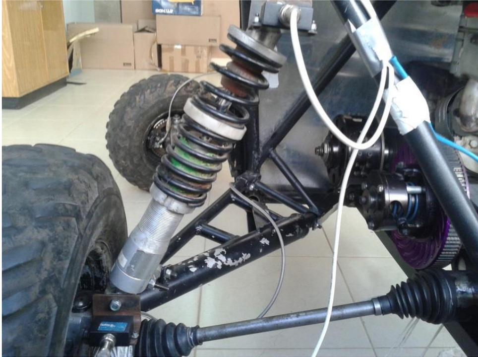
Figura 38: Montagem dos acelerômetros.
