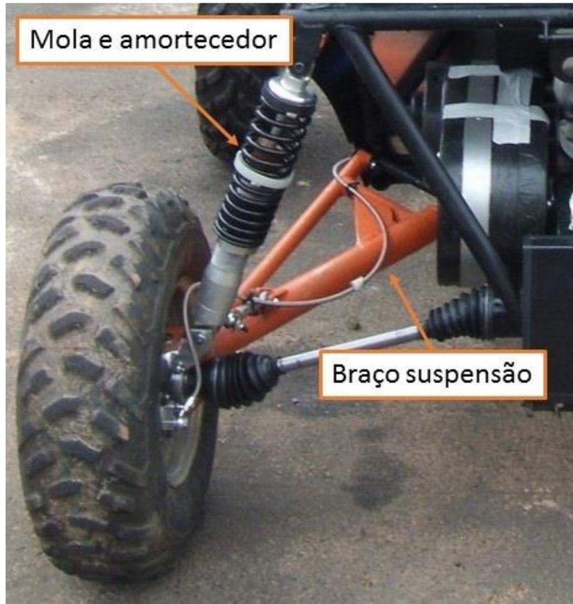
Figura 28: Suspensão traseira do tipo semitrailing arm.
