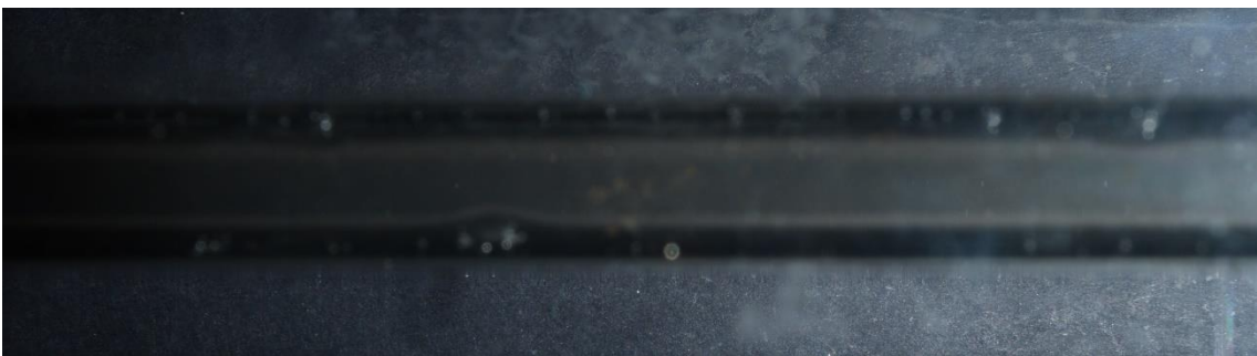
Figura 24 – Foto superior de escoamento ondulado.
