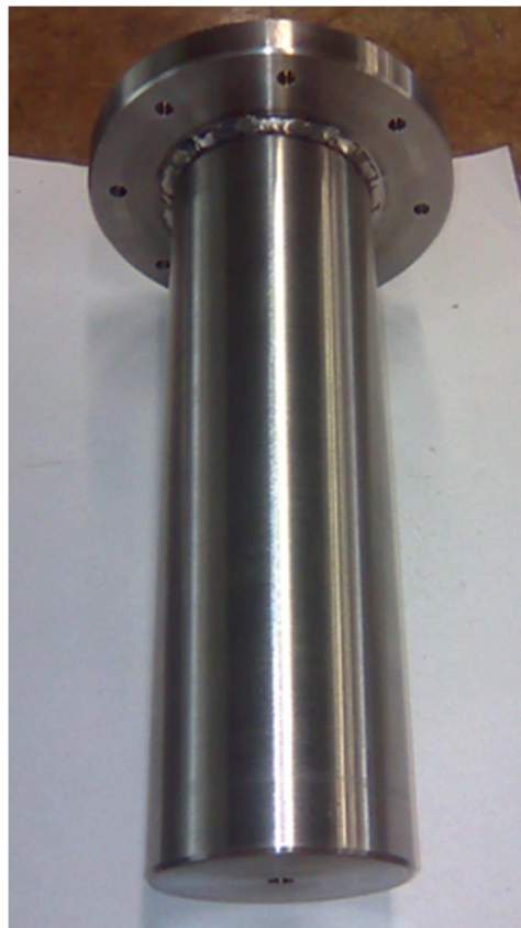
Figura 12 – Cápsula do getter finalizada
